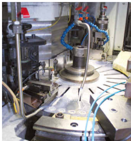
Beim Doppelplanschleifen erzielt die optimale Abstimmung zwischen Prozessanforderungen, Maschine und Kühlschmierstoff Top-Resultate. Bild: Oest, Supfina
